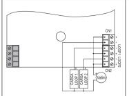
Neste modelo, a fonte de alimentação do transmissor pode ser utilizada também para a alimentação dos loops. Para conexões elétricas deste modelo, desencaixar o display da placa base.
