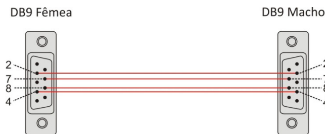
Figura 112 – Confeção do cabo de extensão
